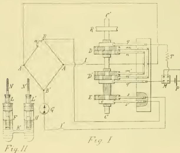
Il disco *E*, avente 3 cm. di raggio, porta un'espansione cilindrica *e* di raggio più piccolo ed è formato da un unico pezzo di ottone. Sulla sua superficie cilindrica sono incastrati 6 settori di ebanite, che nella figura compariscono tratteggiati e che *s'* alternano con i settori conduttori lasciati in bianco; ciascuno di questi si estende per un arco di  $24^\circ$ , mentre ciascuno di quelli occupa un arco di  $36^\circ$ .
