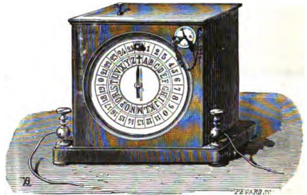
Fig. 148. — Télégraphe à cadran.
