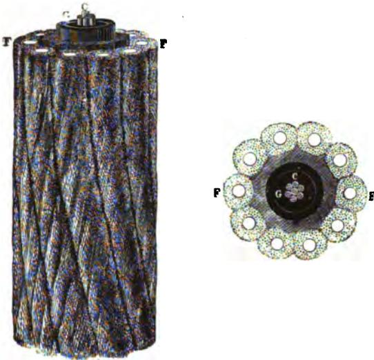
Fig. 146 et 147. — Câble sous-marin (1).
