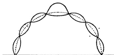
Fig. 140. — Système de quatre nodales.
