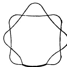
Fig. 135. — Système de quatre nodales.
