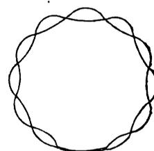
Fig. 137. — Système de six nodales.
