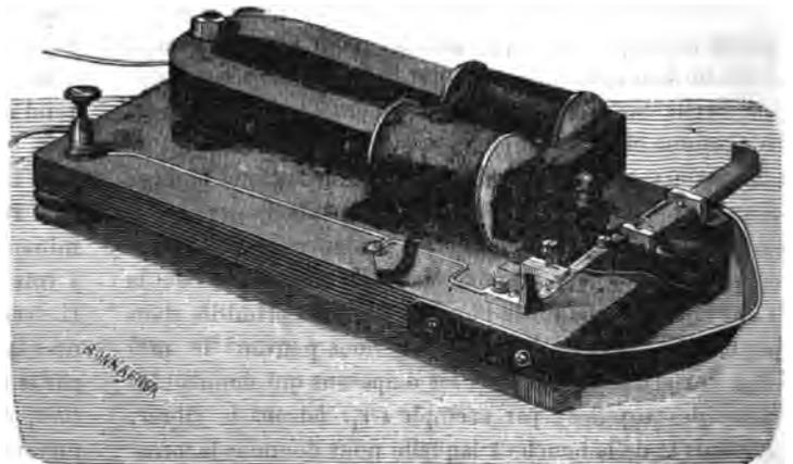
Fig. 119. — Explosur magnéto-électrique.
