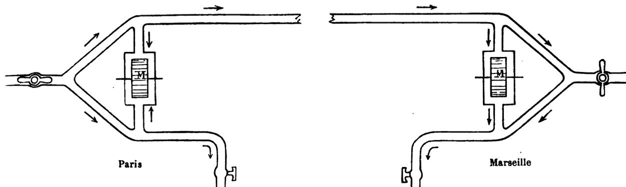
Fig. 152. — Transmission Duplex (méthode du pont de Wheatstone).
