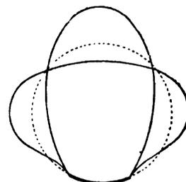
Fig. 133. — Système de deux nodales.
