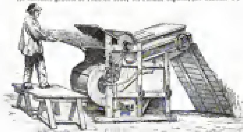
Fig. 123. — Machine à dépiquer le grain avec nettoyage de paille et nettoyage de M. Robert Fournier, à Agès (Lot-et-Garonne).
