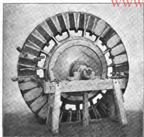
Fig. 4. Armaturring einer Wechselstrom-Maschine in Arbeit.
