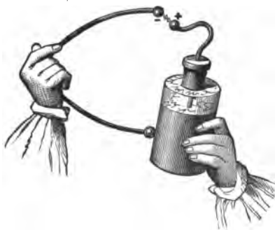
Fig. 5.—Discharge of a Leyden Jar.
