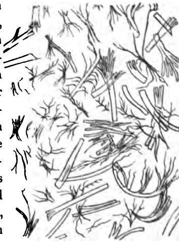
Fig. 38. Fasern aus photographischem Papier. Vergr. 130:1.
