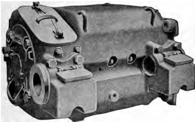
Fig. 230. 125 H. P. Box Frame Motor.
