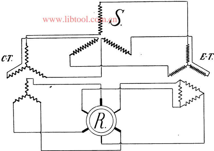
Fig. 29a. Compoundierung bei dreiphasiger Erregung des Rotors.
