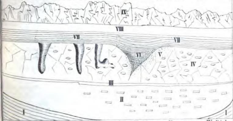
I Mergelthon. - II Dichter Gyps mit Gypsspath. - III Thon mit Fasergyps. - IV Dichter Gyps mit Specksteingeschieben. - V Dichter Gyps mit Dolomitrhomboedern und Bergkrystallen. - VI Fasergyps mit Dolomitrhomboedern. - VII Fasergyps. - VIII Mergelthon mit Gypsschnüren. - IX Dolomitischer Kalk.
