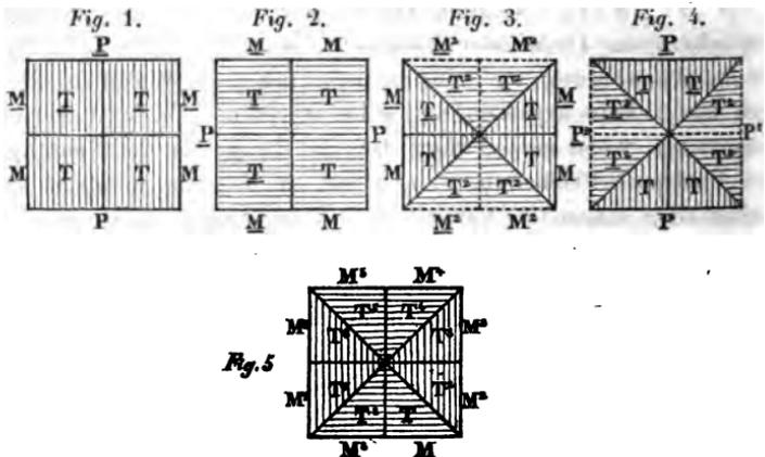
Denke man sich die beiden Zwillinge durch je zwei Diagonalschnitte (Flächen  $\kappa$ ) zertheilt und die Stücke des einen Zwillinges mit den entsprechend liegenden Stücken des andern Zwillinges ausgetauscht, so erhält man in dem einen Falle (Fig. 3) den Penetrations-, in dem andern Falle (Fig. 4) den Juxtapositionsvierling.
