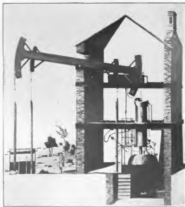
Atmosphärische Dampfmaschine von Newcomen
