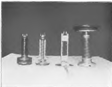
Bellsches Telephon (besonders beachtenswert ist die unhandliche Größe; man vergleiche damit die heutigen Apparate)
