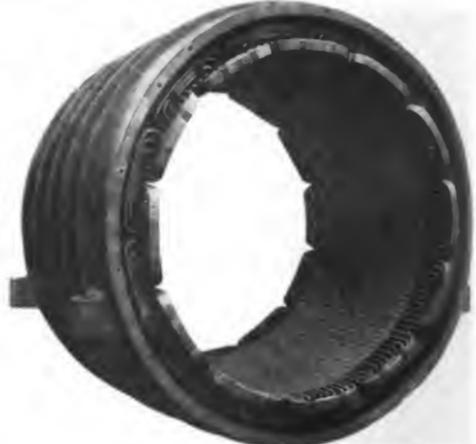
Abb. 11. Stator des Traktionsmotors.
