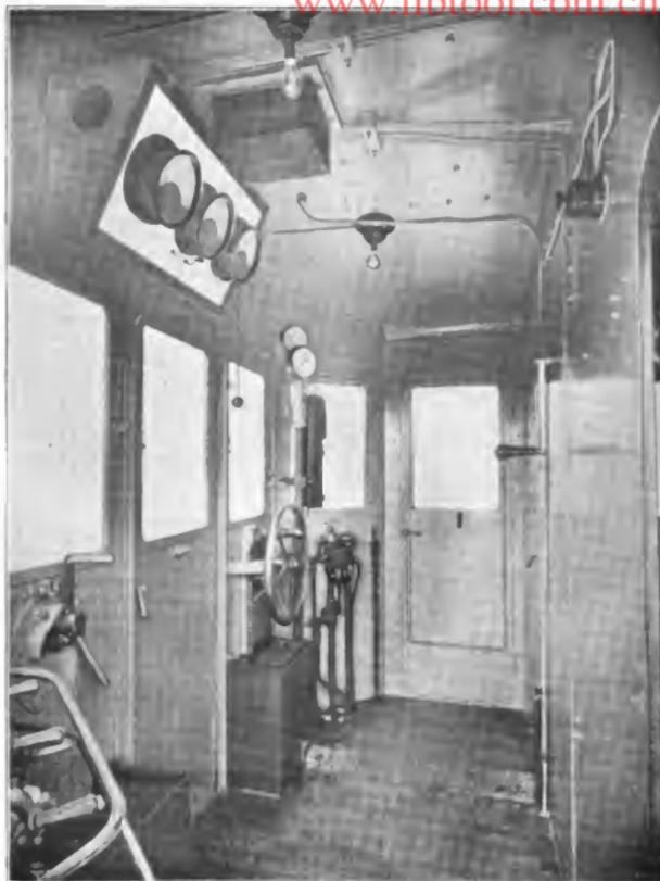
Abb. 2. Führerstand einer elektrischen Oerlikon-Lokomotive.
