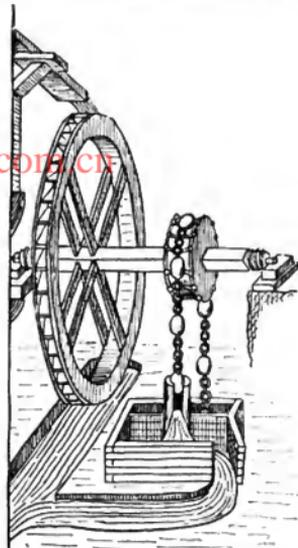
Abb. 3. Durch Wasserrad angetriebene Pumpschneide.
