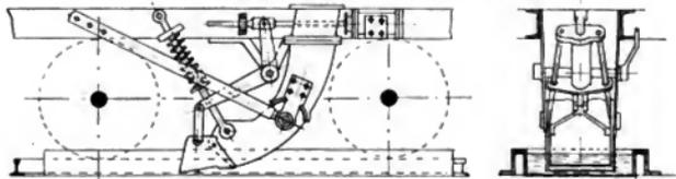
Abb. 8. Bewegung des Schöpfröhres mittels Dampf.
