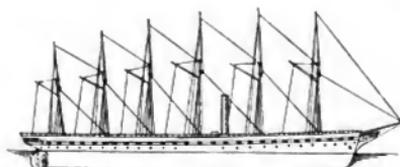
Abb. 6. »Great Britain«. Erster eiserner transatlantischer Schrauben-Post-Dampfer. 1843.
