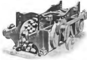
Abb. 6. Zahnradmechanismus der Abtschen Lokomotive für kombinierte Adhäsions- u. Zahnradbahnen.
