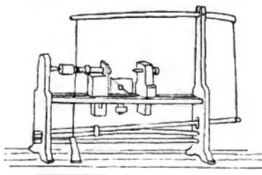
Abb. 2. Metalldrehbank mit Fussantrieb aus der Zeit um 1780.
