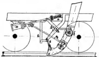
Abb. 7. Bewegung des Schöpfrohrs mittels Pressluft.
