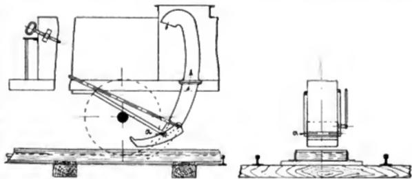
Abb. 6. Bewegung des Schöpfrohres mittels Hebel.
