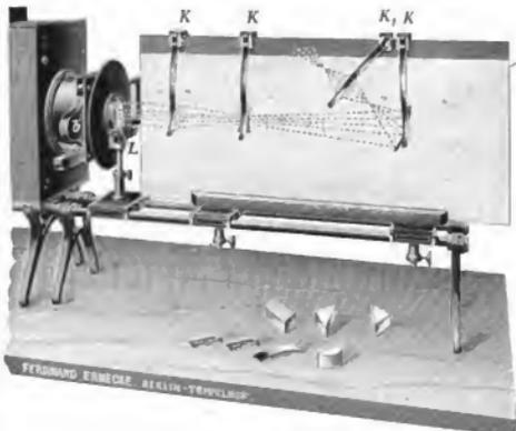
Abb. 1. Projektionsapparat zum Studium des Strahlenganges bei Linsen und Spiegeln.
