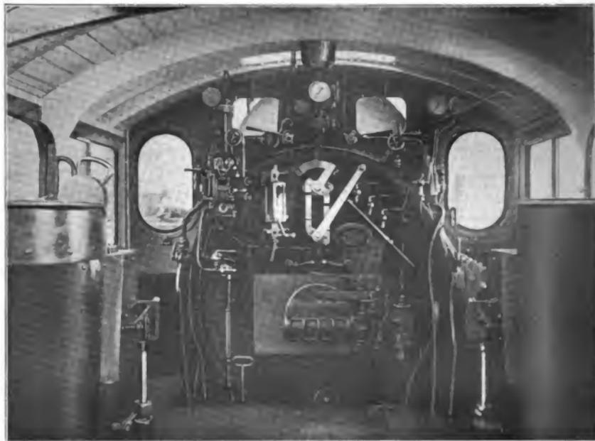
Abb. 1. Führerstand einer Güterzug-Dampflokomotive von A. Borsig.
