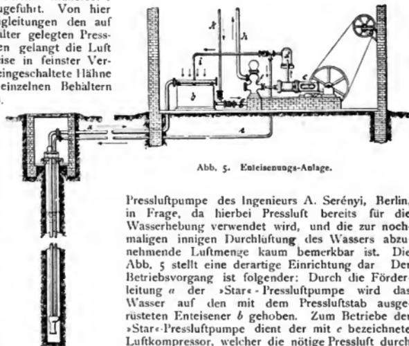
Abb. 5. Enteisungs-Anlage.
