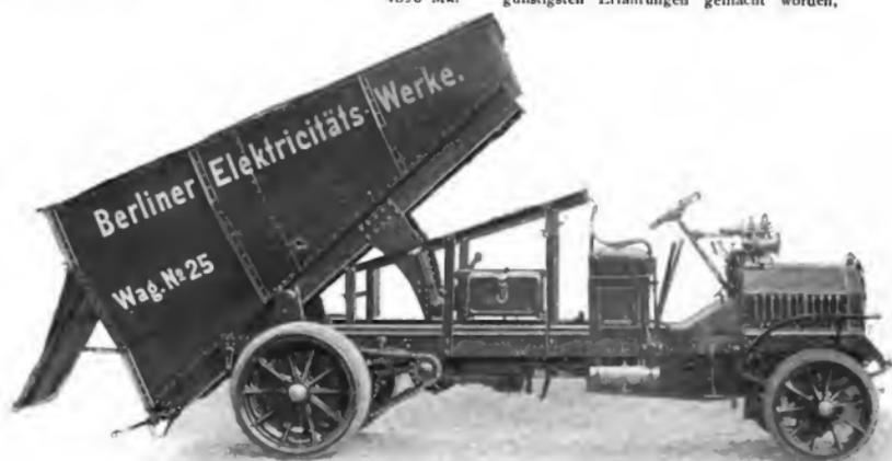
Abb. 2. N. A. G.-Motorlastautomobil Type L 5, 18,20 PS 4 Zyl.-Motor; Kohlenkasten hochgekippt während der Entladung.
