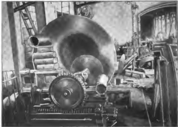
Abb. 3. Das Absägen der Angüsse einer Gussstahlglocke.
