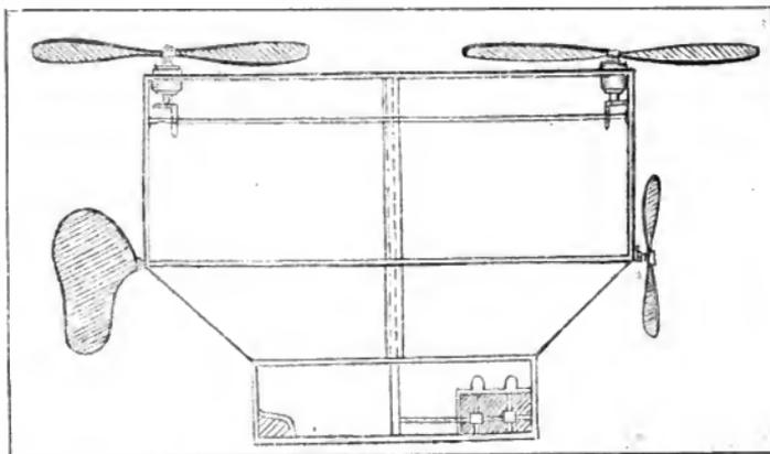
Abb. 1. Schematische Skizze des Schraubensflugers von Santos Dumont.
