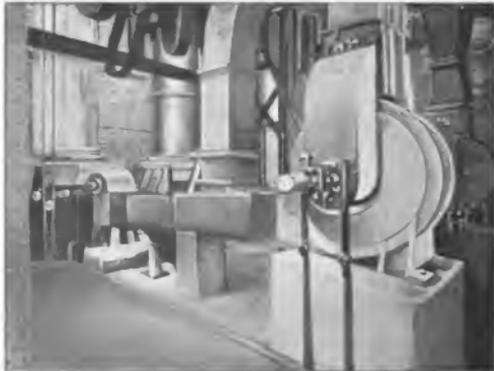
Abb. 8. Reiniger zum Niederschlagen der Bleidämpfe.
