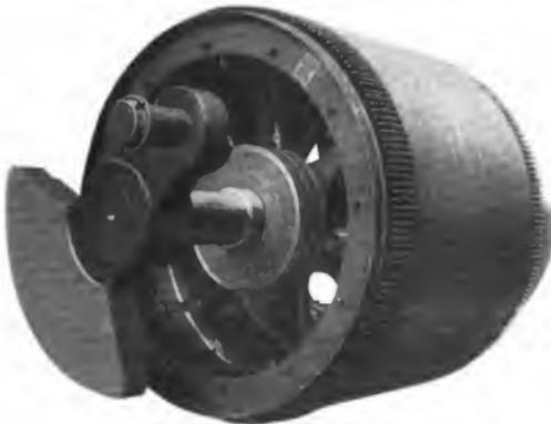
Abb. 10. Rotor des Traktionsmotors.
