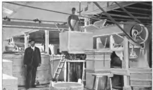
Abb. 4. Schlammvorrichtung.
