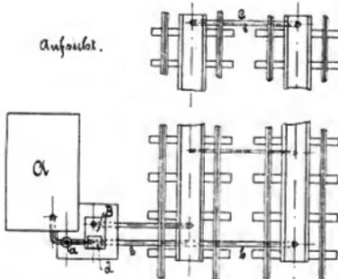
Abb. 5. Selbsttätige Füllvorrichtung für Wasserrinnen.
