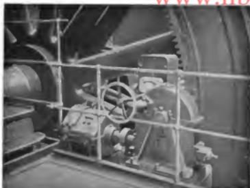
Abb. 5. Drehvorrichtung Modell II für eine Dampfmaschine von 6000 PS.
