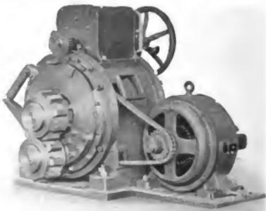
Abb. 2. Elektrisch angetriebene Andrehvorrichtung für eine Dampfmaschine von 3000 PS Leistung.
