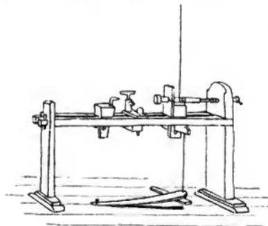
Abb. 1. Metalldrehbank mit Fussantrieb aus der Zeit um 1780.
