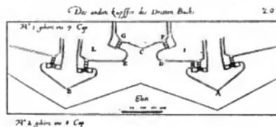
Abb. 5. Flankierungsanlagen hinter den Schultern der Bastione und auch ebenso in der Mitte der Curtine nach L'orain.
