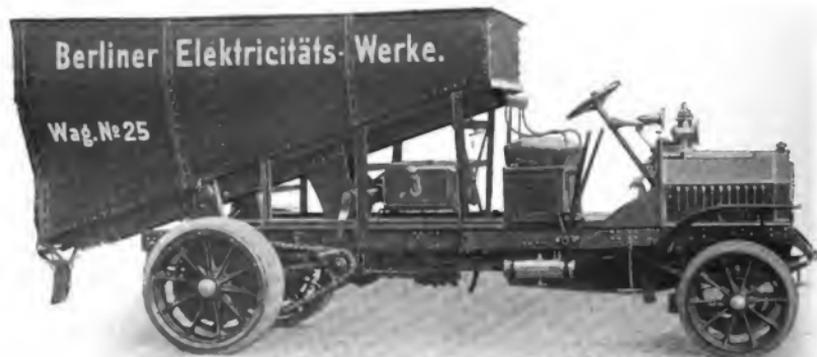
Abb. 1. N. A. G.-Motorlastautomobil Type I. 5. Kohlenkasten beladen in normaler Lage.
