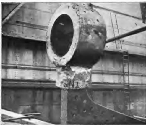
Abb. 5. Ausgeführte Schweißung am Hinterstevn des Dampfers »Oostzee«.
