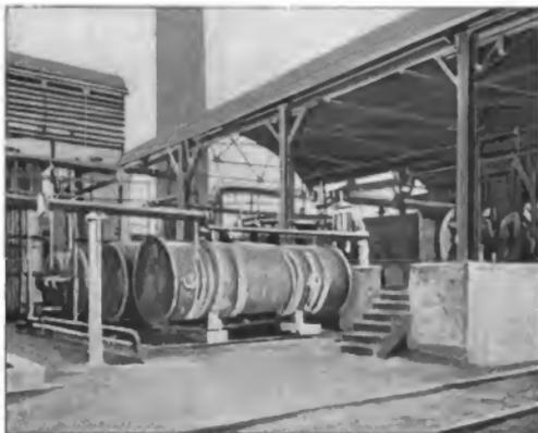
Abb. 12. Apparate zur Erzeugung von Kohlensäure.
