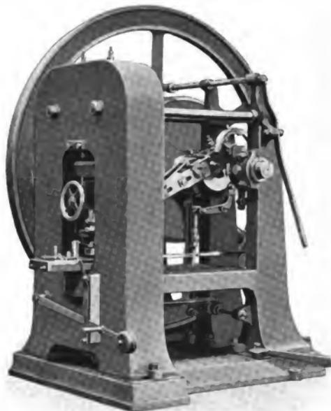
Abb. 6. Automatische Prägepresse von L. Schuler in Göppingen.
