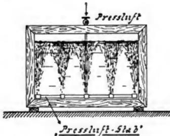
Abb. 3. Die Wirkungsweise des Pressluftstabes.
