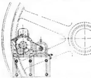
Abb. 4. Abbau der Drehvorrichtung Modell I in die Kraftmaschine.
