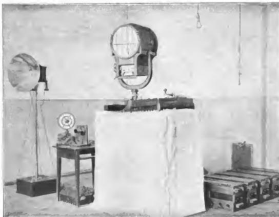
Abb. 1. Torpedoscheinwerfer vom Akkumulator gespeist.
