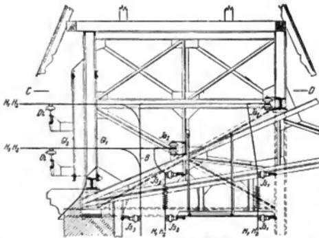
Abb. 5. Austritt der Hochspannung-Freileitungen aus den Sillwerken.
