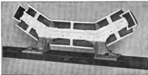
Abb. 4. Obere Tragrolle im Querschnitt.
