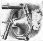
5. Dampfturbine (Schema); S Laufrad, D Dampfdusen.
