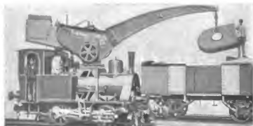
9. Rangierlokomotive mit Drehkran.
