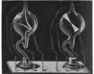
10. Gekrümmter und gerader Weg der Entladung bei schwacher und starker Luftverdünnung in der Röhre.
