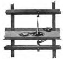
4. Arbeitstisch für Edelsteinschleiferei (Diamantmühle); auf der Schleifscheibe ein kleiner Holzschnebel mit der den Stein fassenden Doppe
