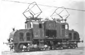
7. Elektr. Vollbahnlokomotive für 15000 Volt (Preussische Staatsbahnen 1920).
