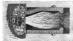
5. Streudüsenzerstäubung für flüssige Brenn- stoffe; H Zuleitungsrohr, Z Zerstäuber mit Streudüse (Fig. 5a), L Luftschieber
