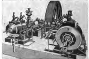
4. Verbundmaschine mit Ventilsteuerung; H Hochdruck-, N Niederdruckzylinder.
