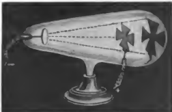
12. Schatten der Kathodenstrahlen auf der fluoreszierenden Glaswand.
