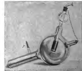
11. Röntgenröhre mit veränderlichem Vakuum und Wasserkühlung; K Kathode, r gekühlter Plattenreflektor, p luftabsorbierende Schicht.
