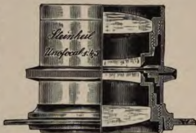
FIG. 44. "Unofocal" Lens. C. A. Steinheil Söhne.
