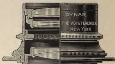
FIG. 43. "Dynar" Lens. Voigtländer & Son Optical Co.
