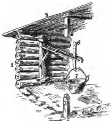
52. Watarnyk . 1. zrąb; 2. dach; 3. podpora dachu tu przecięta; 4. słup; 5. werkluh ; 6. berfela ; 7. kocioł.
