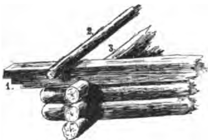
33. Górny węgiel. 1. Obrúbyna »płatwie«; 2. pidkrivna łata ; 3. szpara, którą uchodzi dym ze strychu.
