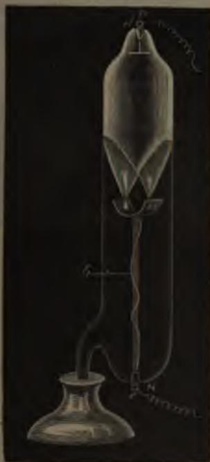
M. Crookes les réalise à l'aide d'une puissante bobine d'induction, mais on peut aussi les obtenir à l'aide de la machine électrique, dans des conditions évidemment plus simples.
