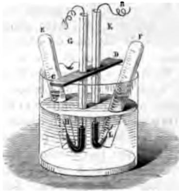
les cloches dans un vase quelconque ; mais alors le niveau de l'eau baisse à l'intérieur pendant que les gaz se dégagent, et la surface immergée des électrodes diminue. On verra dans la figure que cette circonstance affaiblit progressivement l'intensité du courant et diminue d'autant la décomposition.
