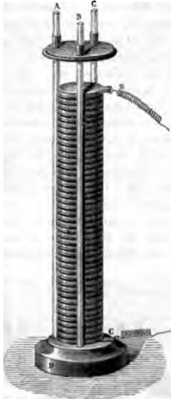
cuivre et de zinc sont superposés alternativement et chaque paire est séparée de la suivante par une rondelle mouillée de drap ou de castor. La colonne entière est soutenue par trois tiges de verre verticales A, B, C, enchâssées dans un socle en bois D, et maintenues à leur sommet par un disque percé de trois trous.
