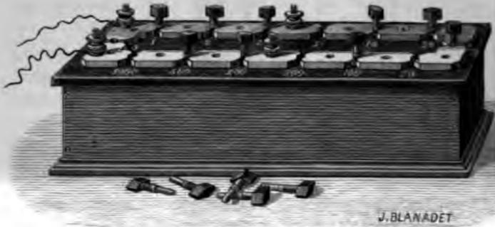
nombre entier d'ohms jusqu'à une certaine limite. On dispose habituellement de la valeur des bobines comme de celle des poids composant une boîte à poids. Ainsi la boîte représentée (fig. 38) comprend treize bobines valant respectivement en ohms,
