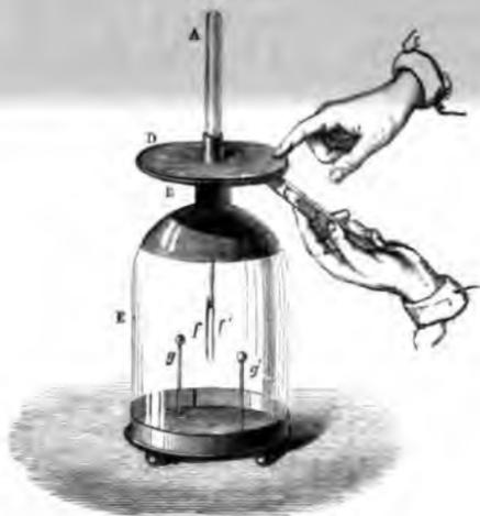
formée de deux rectangles égaux de zinc et de cuivre soudés entre eux. Tenant le zinc Z de la main gauche, il touche avec le cuivre C l'un des plateaux B de l'électroscope condensateur, pendant qu'il fait communiquer l'autre avec le sol par la main droite. Il supprime ensuite ces communications, sépare les
