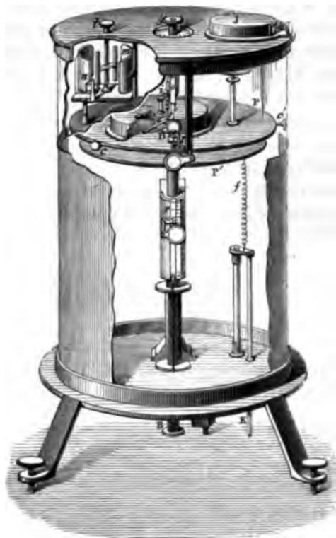
de la balance, réunis à la tige verticale *o* par l'intermédiaire d'une matière isolante. On relève cette tige à volonté par l'intermédiaire de la vis micrométrique *b* dont on compte les tours par l'intermédiaire d'une petite règle, et les fractions de tour par un vernier à la tête. Des loupes permettent de viser entre deux
