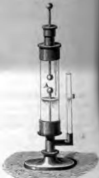
par l'effet de la dilatation de l'air, quand on le fait traverser par une puissante décharge. Quant au thermomètre de Kinnorsley, c'est un vase fermé A (*fig.* 132), contenant de l'eau et de l'air et dans lequel on fait passer une étincelle entre les boules situées toutes deux dans l'air ; au moment de la charge, le liquide est projeté par un tube communiquant
