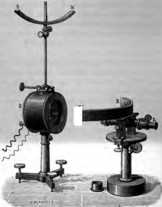
qui dans quelques appareils est circulaire et doit alors être placée de manière que le miroir soit au centre de courbure. Cette disposition offre l'avantage que la lunette est toujours au point et que les lectures faites sur la règle sont proportionnelles aux déviations, même quand celles-ci ne sont pas très petites; mais elle exige un réglage dont il vaudrait mieux être dispensé.
