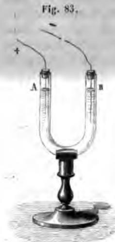
Mais avec des précautions convenables on peut obtenir les métaux alcalins ou alcalino-terreux par voie électrolytique. C'est ainsi que Davy soumit à l'action d'une pile de 250 couples un fragment de potasse caustique humide; il vit à l'électrode positive se dégager une quantité considérable d'oxygène pur, et au fil négatif se rassembler de petits globules
