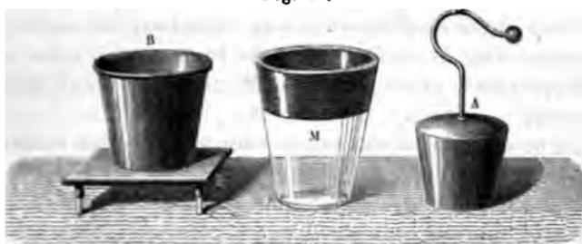
out dans un baquet contenant encore de l'eau, qui constitue le conducteur extérieur B. Quand l'appareil avait été chargé à la manière ordinaire, il l'enlevait, vidait le liquide intérieur et remplaçait le flacon dans les mêmes conditions en mettant à l'intérieur et à l'extérieur de l'eau nouvelle qui n'avait point été électrisée; la charge de l'appareil n'avait pas sensiblement diminué.
