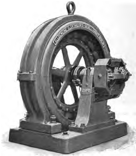
Fig. 206. Drehstrommaschine der A. E.-G. mit gekuppelter Erregermaschine.
