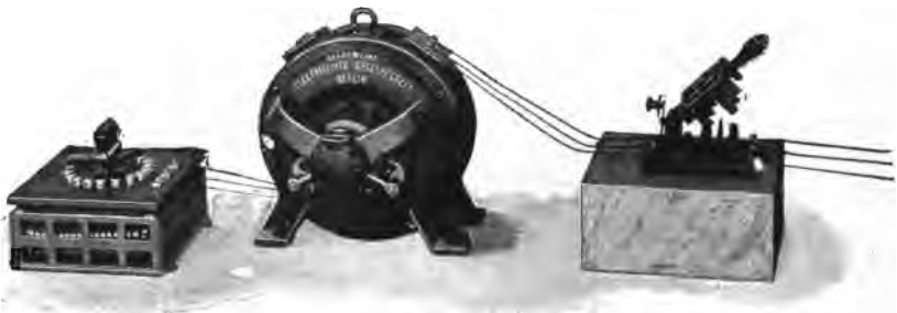
Fig. 210. Drehstrommotor der A. E.-G. mit Schleifringanker. Anlaß- und Regulierwiderstand in der Läuferwicklung.
