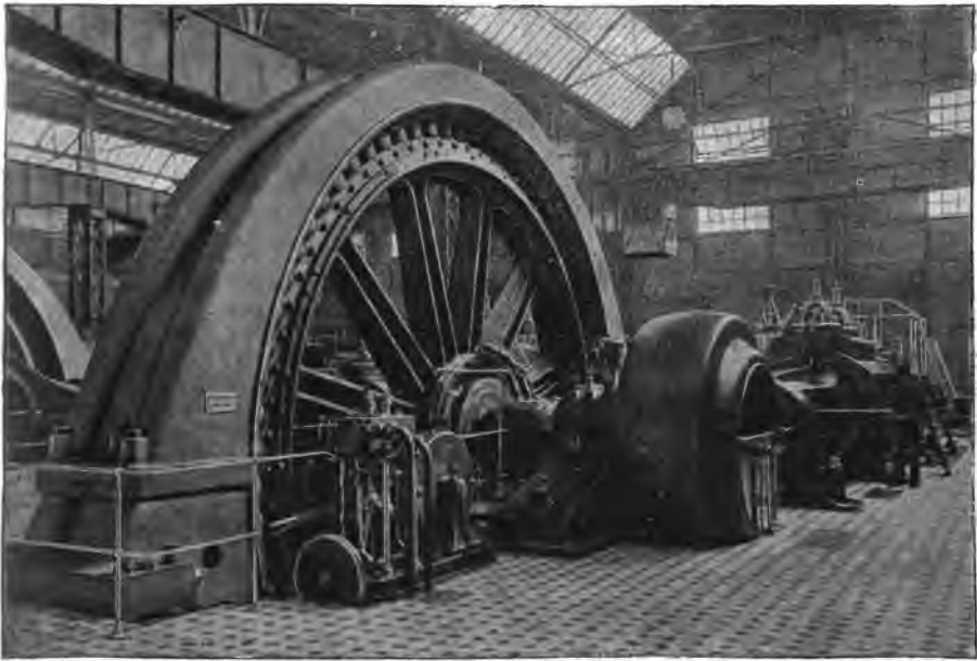
Fig. 205. Drehstromdynamo der A. E.-G. durch Dampfmaschine betrieben. 3000 Kilowatt, 6000 Volt.
