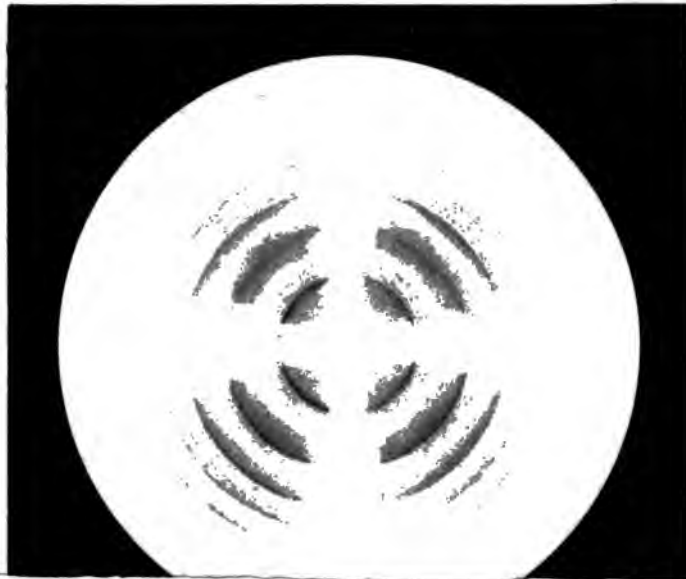
Fig. 1. Cristal uniaxe taillé perpendiculairement à l'axe, et vu entre deux nicols croisés à angle droit
