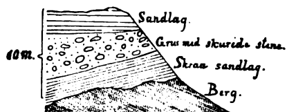
IV. Profil fra en jernbaneskjæring ved Tørmoen.
